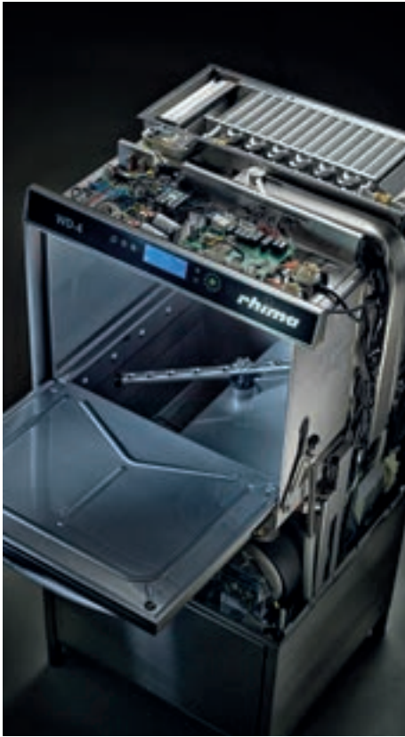
Die elektronische Steuerung befindet sich geschützt und leicht zugänglich auf der Oberseite der Maschine.
